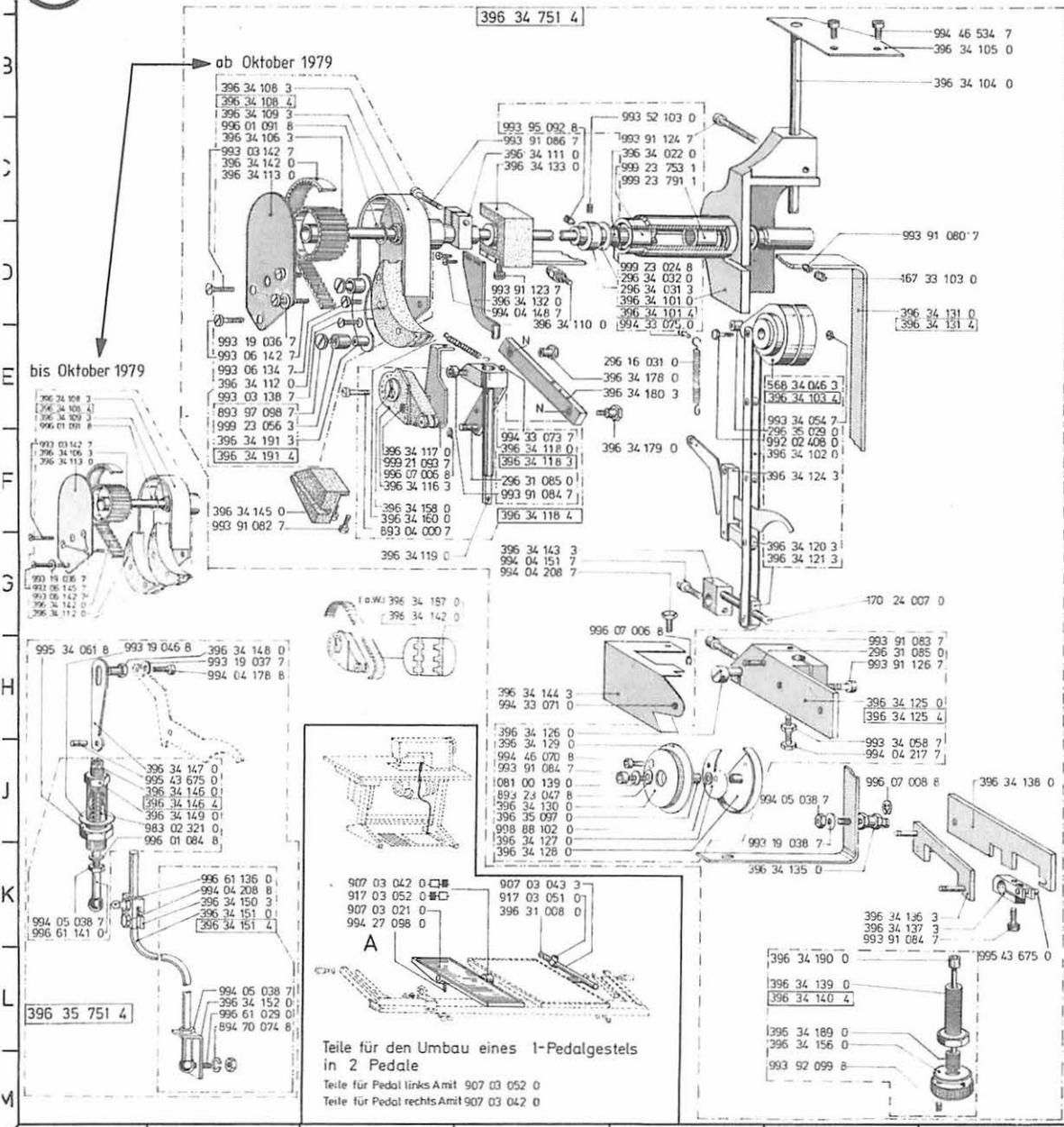
Teile für den Umbau eines 1-Pedalgestells in 2 Pedale
